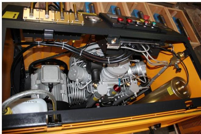
Компрессор «БАРОС-330ЭТ» является 3-х ступенчатым компрессором подачи воздуха для дыхания с тремя цилиндрами, масляной смазочной системой под давлением и системой воздушного охлаждения.
