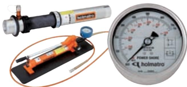
Гидравлические распорки раздвигаются при помощи ручного насоса (720 бар) со шлангом и манометром для контроля максимально допустимого давления для крепи выбранной длины. Макс. нагрузка и усилие подъёма: 10.1 т / 100 кН
