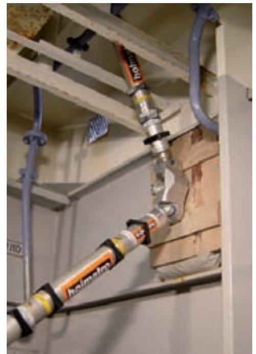
3-сторонние поворотные опоры используются для установки стоек в различных направлениях.
