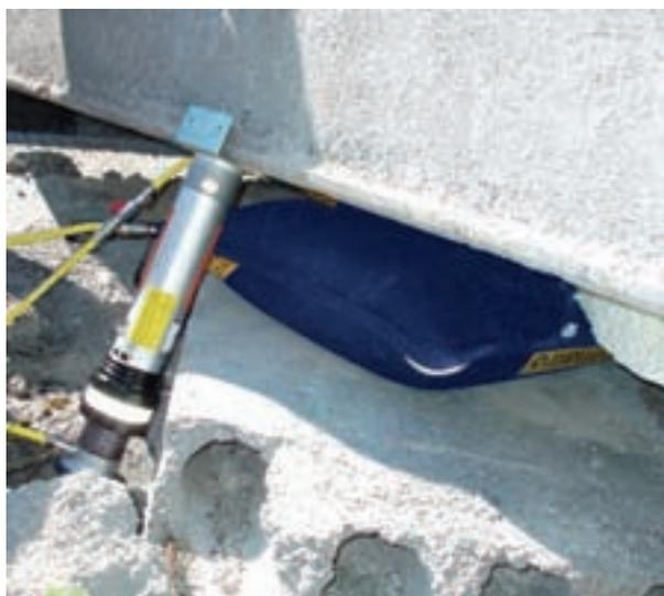
Распорка с автоматическим фиксатором поддерживает подъёмную подушку.
