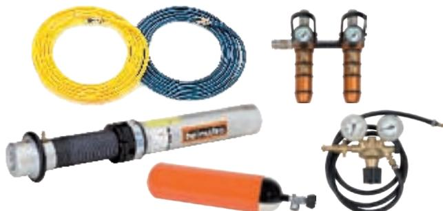
Пневматические распорки работают под давлением 8 бар от пневмосистемы, состоящей из баллона со сжатым воздухом, редуктора, манометра и воздушных шлангов. Максимальная нагрузка: 10.1т / 100 кН. Максимальное усилие подъёма: 0.4т / 4.0 кН.
