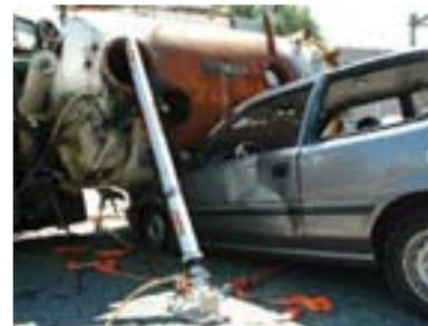
Стабилизация грузового автомобиля гидравлическими распорками с контргайками.
