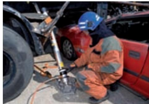
Стабилизация грузового автомобиля гидравлической распоркой с контрражкой.
