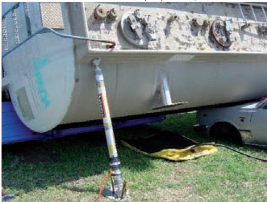
Пневматическая распорка с автоматическим фиксатором используется для вспомогательного закрепления в операциях по подъёму грузового автомобиля.
