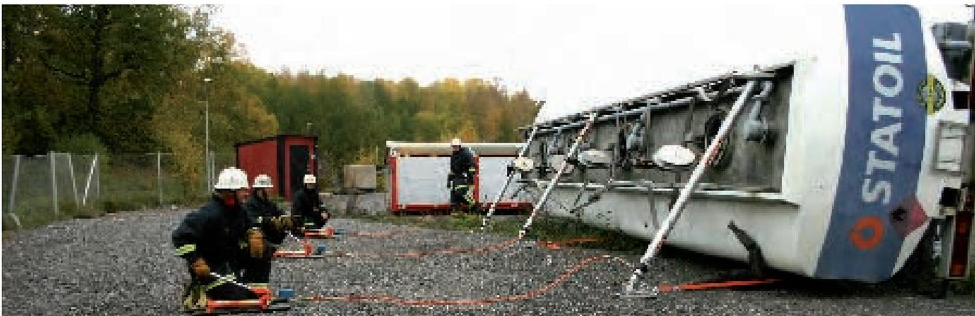
Закрепление и подъем тяжелого грузовика гидравлическими крепами PowerShore™.
