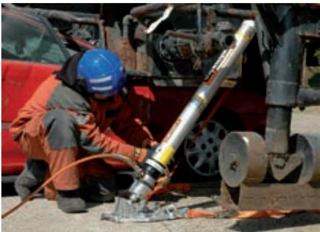
Крепы могут быть установлены под различными углами.
