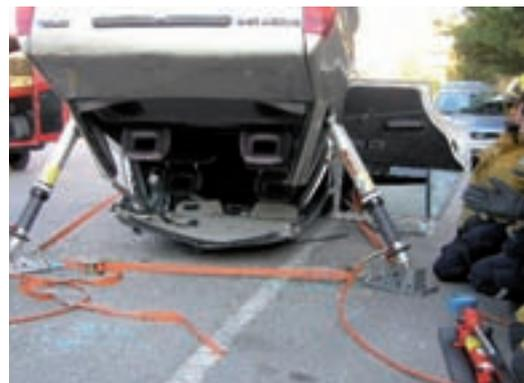
Стабилизация легкового автомобиля гидравлическими распорками с контргайками.
