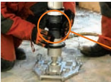
Груз фиксируется вручную контргайкой.
