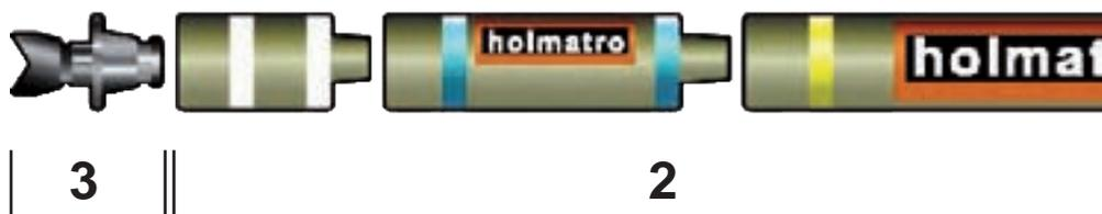
Все крепи, в зависимости от их длины, имеют допустимую максимальную нагрузку 10.1 т / 100 кН с коэффициентом безопасности 4:1 (смотри график на стр. 20).
